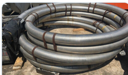
شلنگ کنترل BOP
